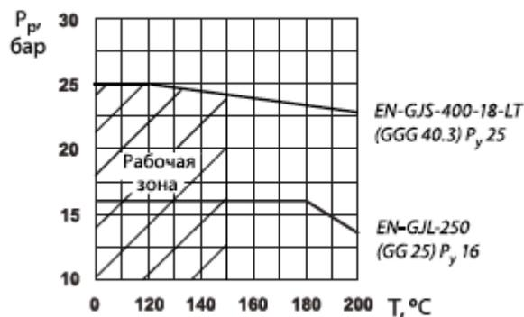
Рис. 4. Зависимость рабочего давления от температуры перемещаемой среды.
