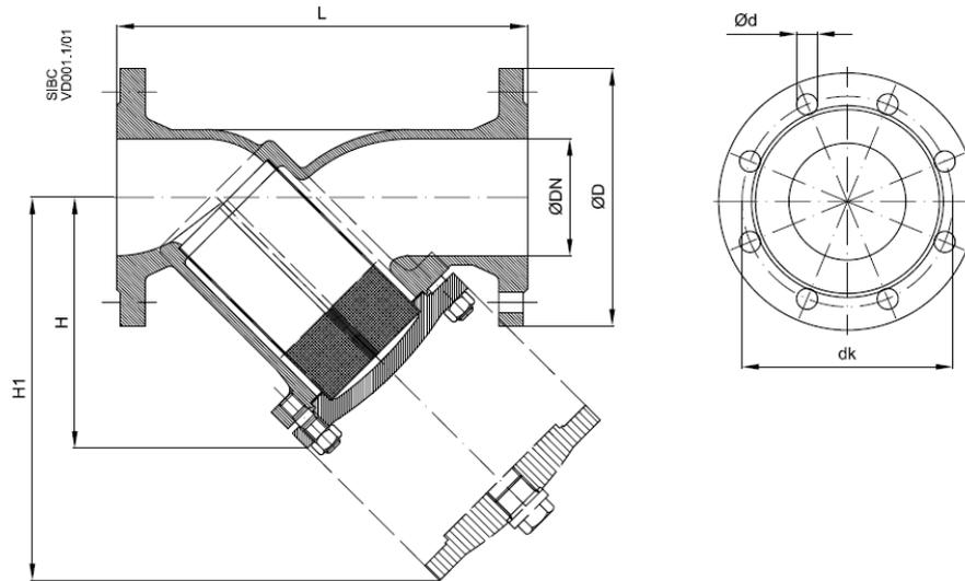
Рис. 5. Габаритные размеры фильтра сетчатого типа FVF.
